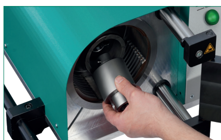
Einsetzen des Formstutzens mit Bajonettverschluss – ohne jegliches Werkzeug
