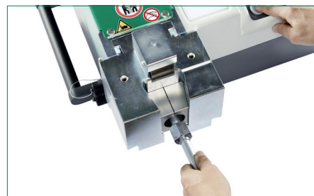
Werkzeugkopf zum 37°-Bördeln mit manueller Druckeinstellung
